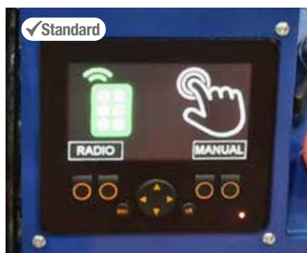
Écran à couleur LCD pour la gestion de la machine LCD-Farbbildschirm zur Verwaltung der Maschine
